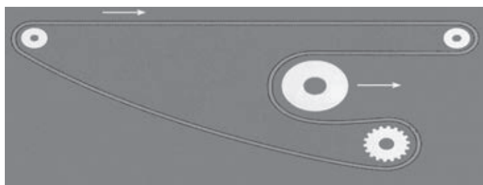
Figuur 2: Hier is sprake van 2 x neusovername met positieve buigrichting en negatieve buiging om een span-as. Voor de minimale diameters van overname neus en negatieve omleidrol zie blz. 3.2
